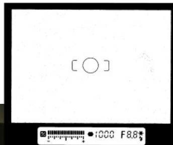
Es la primera Réflex de FM con AF, tiene tres puntos de enfoque, con truco, Spot, con el punto central y el modo Multi que selecciona los tres puntos de enfoque al mismo tiempo, enfoque continuo y single, todo movido con un enfoque por tornillo que no suena demasiado para la cantidad de cristal
